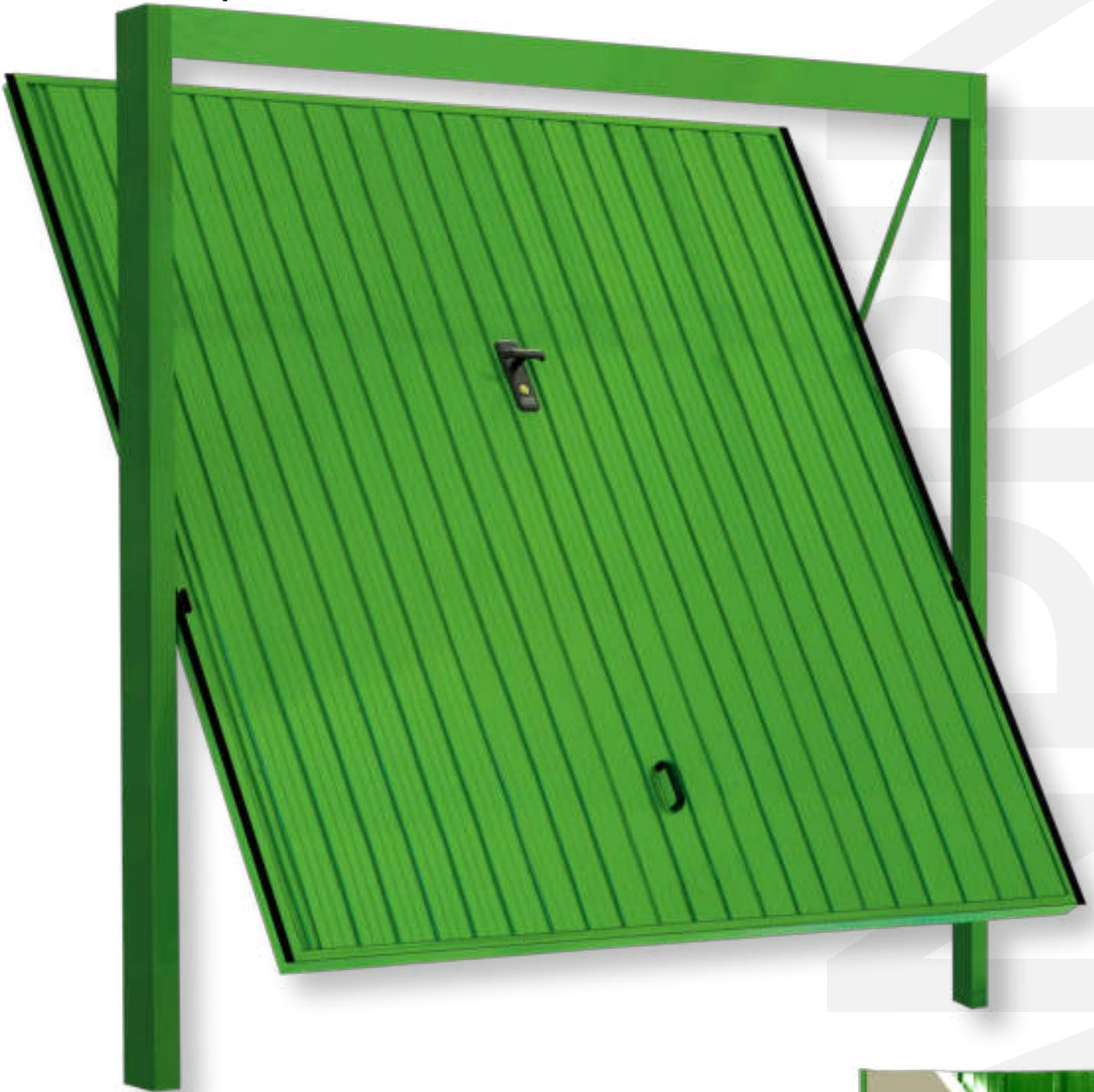
Porta fornita con spalle da 5 cm. pronta da installare, con battente a doppia parete in lamiera zincata grecata e pannello interno in Stiferite Class-S. Questa porta consente un'ottima tenuta termica viene fornita normalmente con lamiera grecata d'acciaio 6/10 o 8/10 all'esterno e lamiera grecata 6/10 all'interno, la coibentazione tra le due lamiere viene eseguita con Stiferite Class-S ignifuga e idrorepellente.
