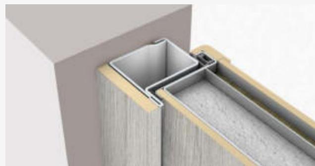
6 Soluzione posa telaio C centro muratura con profili di copertura telaio esterno
