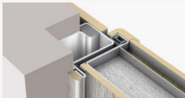
3 Soluzione telaio R con profili di copertura telaio esterno
