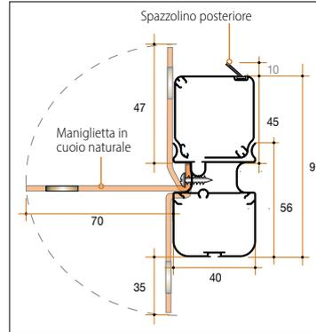
**Compensatore e guida montata.**
