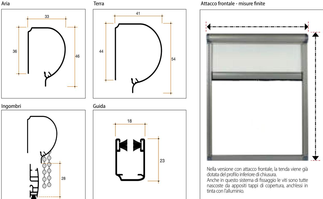
Nelle tende oscuranti per porta finestra, se esposte direttamente al sole, consigliamo di lasciare qualche millimetro di spazio nella parte superiore per consentire all'aria calda che si crea tra vetro e tessuto di fuoriuscire: se ciò non è possibile, avvisare l'utilizzatore di tenere sollevata la barra maniglia qualche centimetro.
