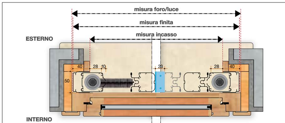
**Sezione verticale 2 battenti con staffa attacco superiore**
