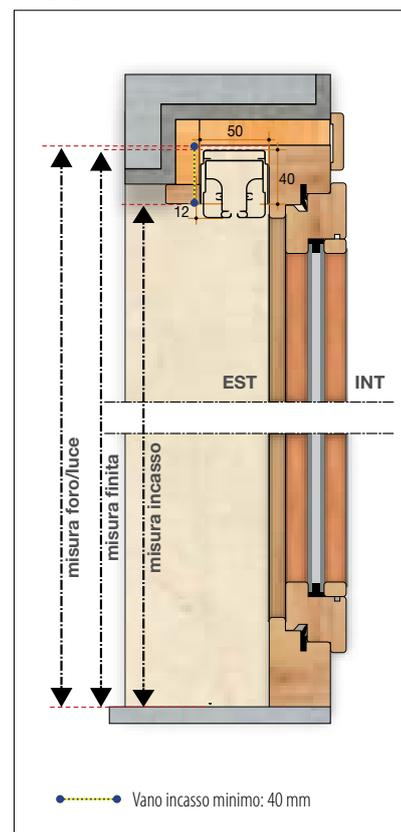
2 Dettaglio V2 – Sezione verticale a due battenti
