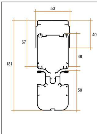
**Sezione orizzontale 1 battente con incasso 3 lati e Copri Cassa Facile (di serie)**
