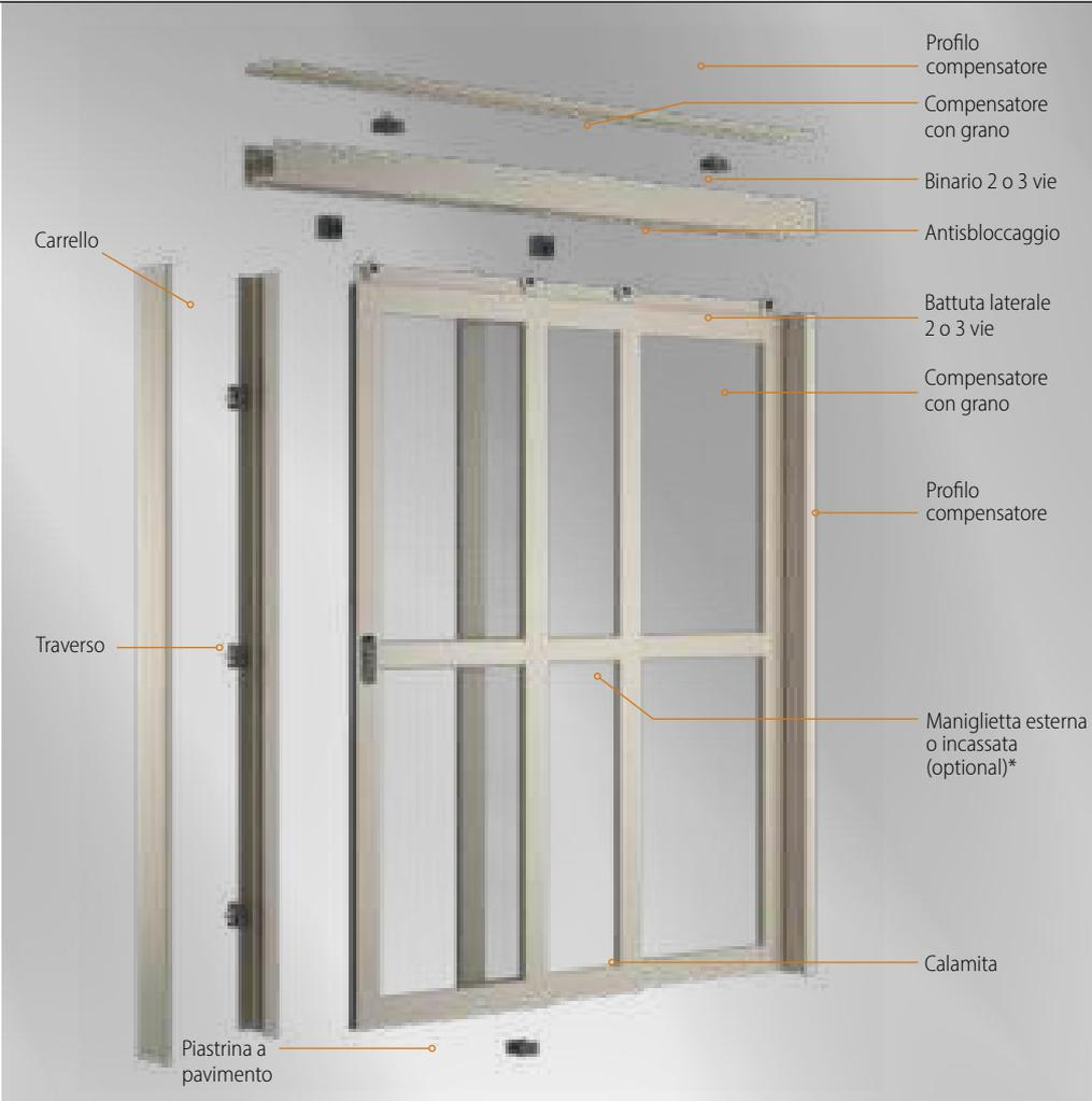
\*Maniglietta incassata (optional). Ideale in presenza di spazi ridotti, si inserisce e scompare nel profilo dell'anta. Se non diversamente specificato sarà posizionata ad altezza traverso e sull'anta in cui è rappresentata la maniglietta tradizionale nelle tipologie di apertura: se interna ed esterna sulla stessa anta, quella interna sarà posizionata ad altezza traverso mentre quella esterna leggermente più in alto.
