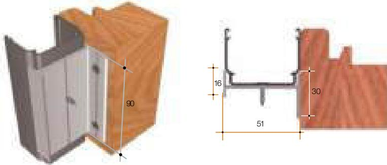
Il compensatore in alluminio risolve brillantemente la problematica di installazione in presenza di avvolgibili in monoblocco con cielino ispezionabile dall'esterno, in quanto consente di ancorare la parte superiore della zanzariera direttamente sul serramento.
