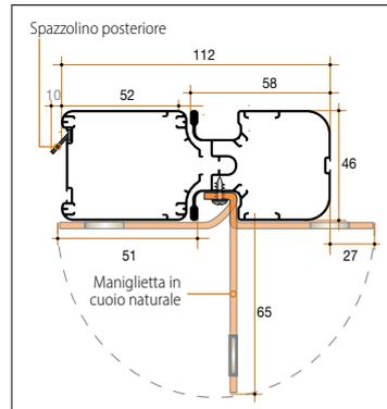
**Compensatore e guida montata.**
