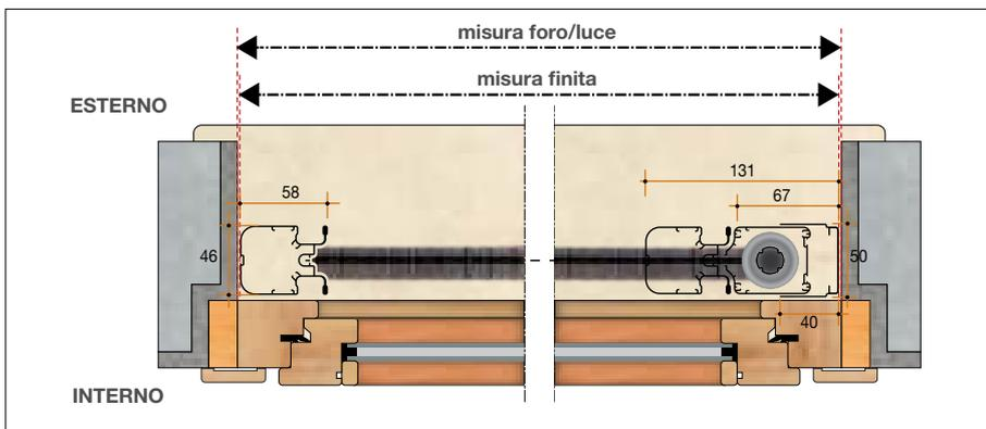
Sezione orizzontale 2 battenti con staffa attacco superiore
